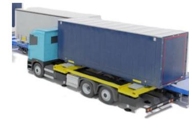
**4** Lade-/Transporteinheiten: Container, Wechselbrücken
