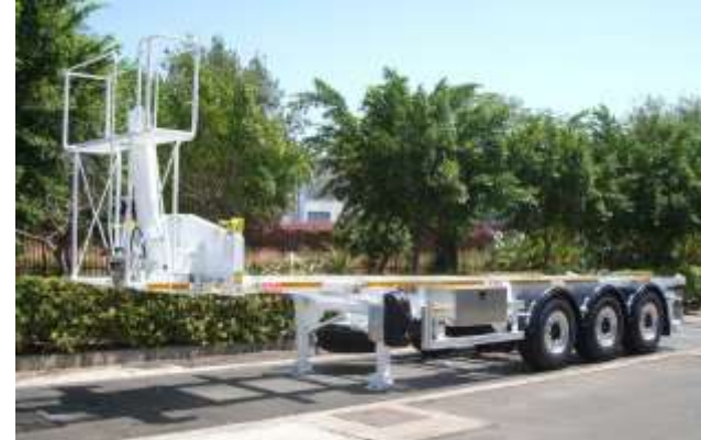
Container-Chassis mit Teleskop-Funktion
