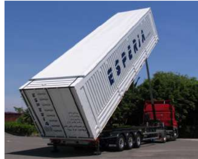
45ft Open Top (ca. 90m 3 Ladevolumen) auf Kippchassis
