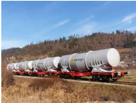
Modulares Waggon- und Ladeeinheiten-System für unterschiedliche Ladegüter
