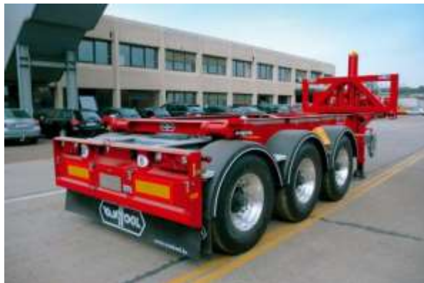
Container-Chassis mit Kippfunktion
