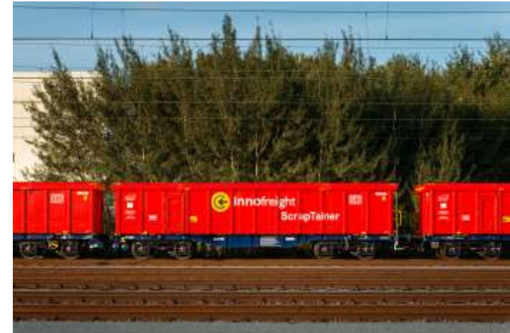
Modulares Waggon- und Ladeeinheiten-System für unterschiedliche Ladegüter
