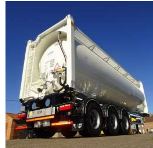
Container mit Druckentladung
