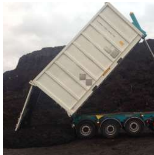
Kippentladung eines Drucklos-Containers
