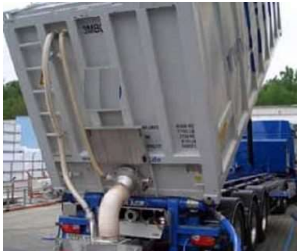
Silo-Entladung mit Zellenradschleuse
